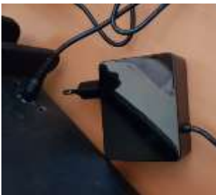
Figura 1- Collegare il kit mediante alimentatore 12V alla rete elettrica 220v.
